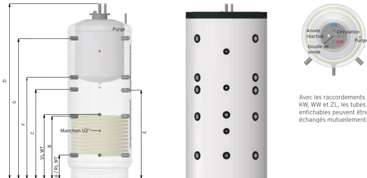
Avec les raccords KW, WW et ZL, les tubes enfilables peuvent être échangés mutuellement.
