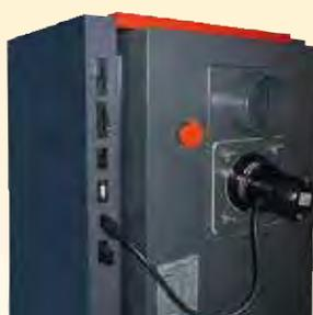
Les chaudières ATMOS PX sont équipées d'un ventilateur d'aspiration de fumée pour faciliter le tirage sur des conduits de fumée capricieux. La chaudière n'est pas équipée d'un serpentin de surchauffe car il n'y a pas de risque de surchauffe en cas de coupure d'alimentation électrique.
