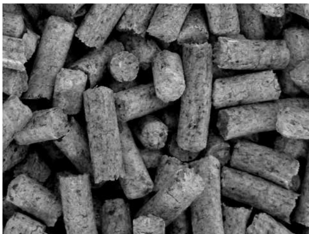
Pellets en bois d'une mauvaise qualité - foncés, avec l'écorce (points noirs)
