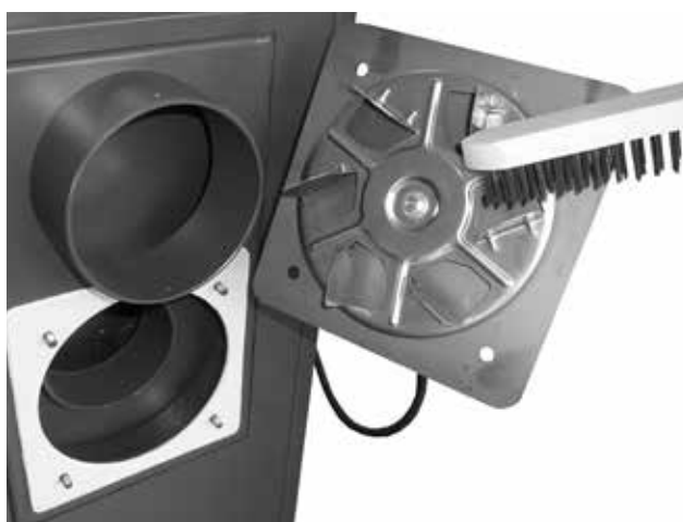
Exemple de nettoyage de la roue et vérifier la droiture de girouette sur ventilateur extrait (pour les chaudières D31P)
