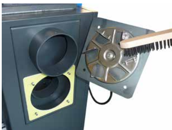
Nettoyage de la roue mobile et contrôle de la perpendicularité des pales du ventilateur de tirage
