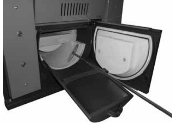
Espace inférieur de la chaudière ouvert, avec espace circulaire , et récupération des cendres à l'aide d'un tisonnier et cendrier
