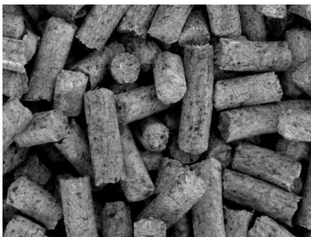
Pellets en bois d'une mauvaise qualité - foncés, avec l'écorce (points noirs)
